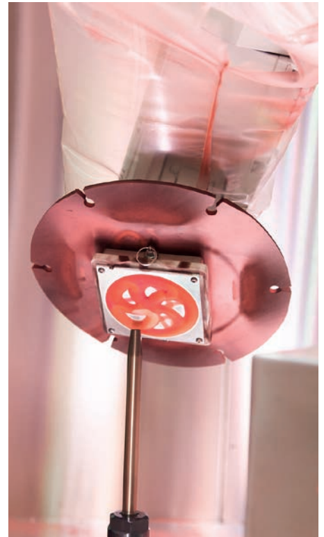
Innovatives Kaltschweißverfahren SP3D (Supersonic 3D Deposition)
