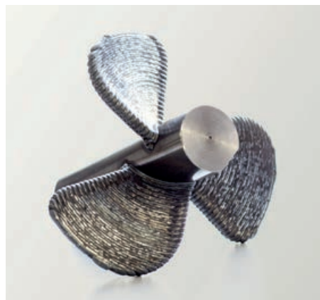
Studie eines Schiffspropellers mit auf ein Halbzeug aufgeschweißten Blättern
