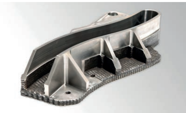
Studie eines Schiffspropellers mit auf ein Halbzeug aufgeschweißten Blättern
